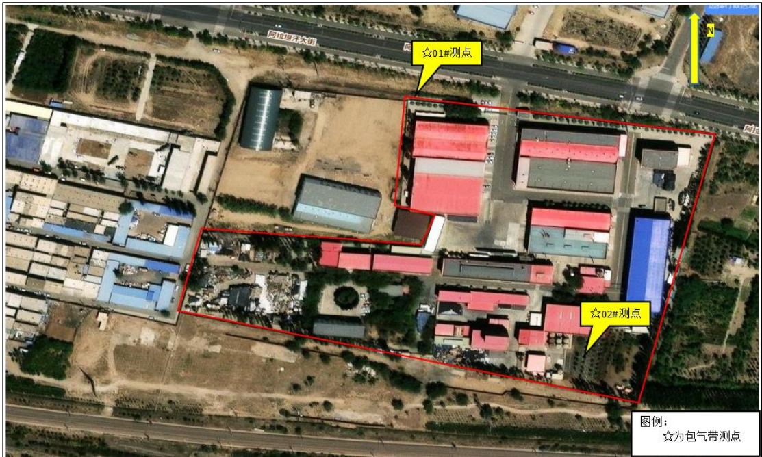
图 5.3-4 地下水包气带监测点位图
