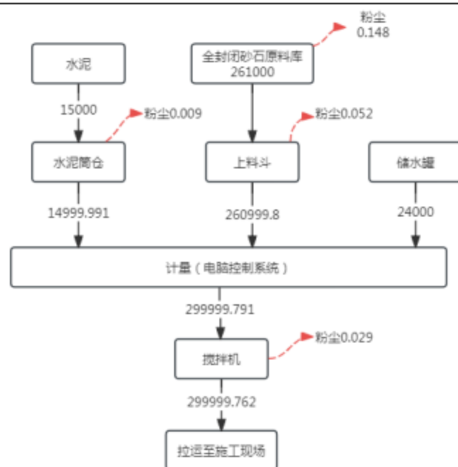
图 2-2 水稳混合料生产线物料平衡图 (t/a)
