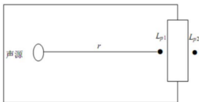
图 6.2-19 室内声源等效为室外声源图例
