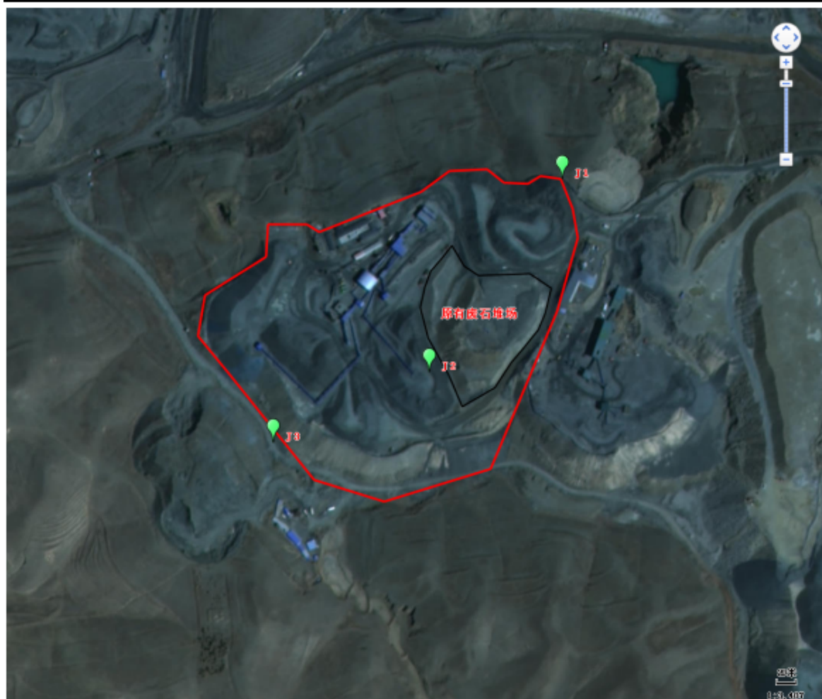
图 8.2-1 地下水跟踪监测井布设示意图
