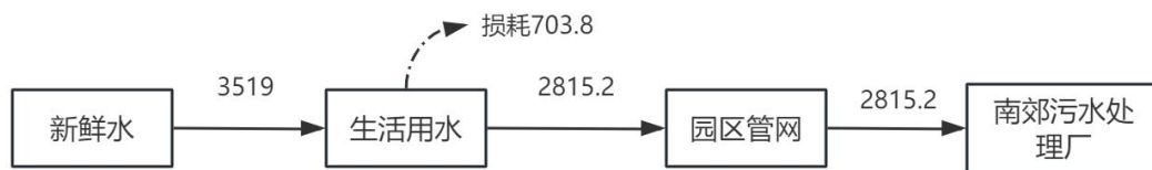
图 2-1 本项目水平衡图 单位: \text{m}^3/\text{a}
