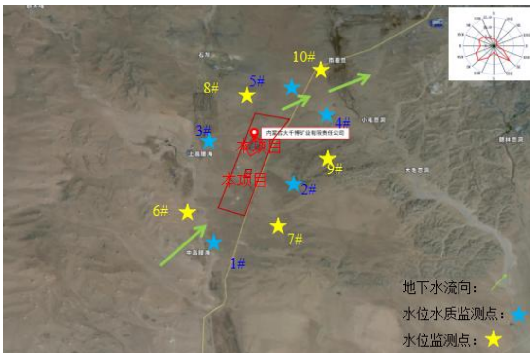
图 5.2-1 地下水监测点位图（比例尺 1：100000）
