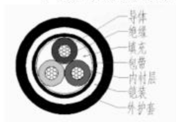
图 3-5 ZC-YJY23 3×240 结构示意图
