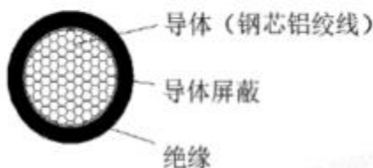
图 4-8 JKLGYJ1×120/7 结构示意图
